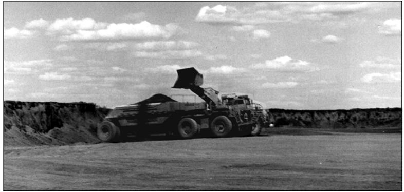
Photo 2: Abbau der rund 4 m mächtigen Bauxitschicht (Aufnahme: Ewers 1997)
